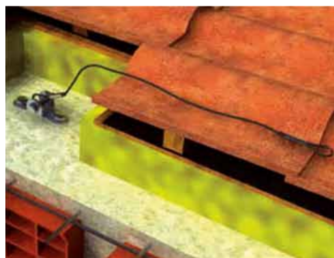
Configurazione (codice RNVT08 ) montata su tetto in laterocemento.
